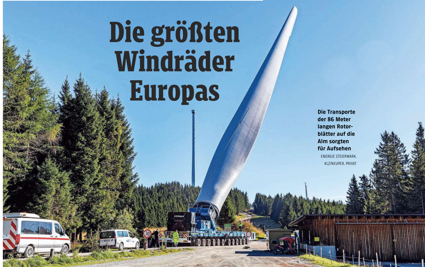
Das Rotorblatt kann beim Transport aufgestellt, zur Seite geneigt und gedreht werden
