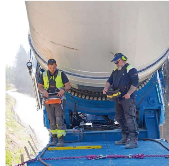
Das Rotorblatt kann beim Transport aufgestellt, zur Seite geneigt und gedreht werden
